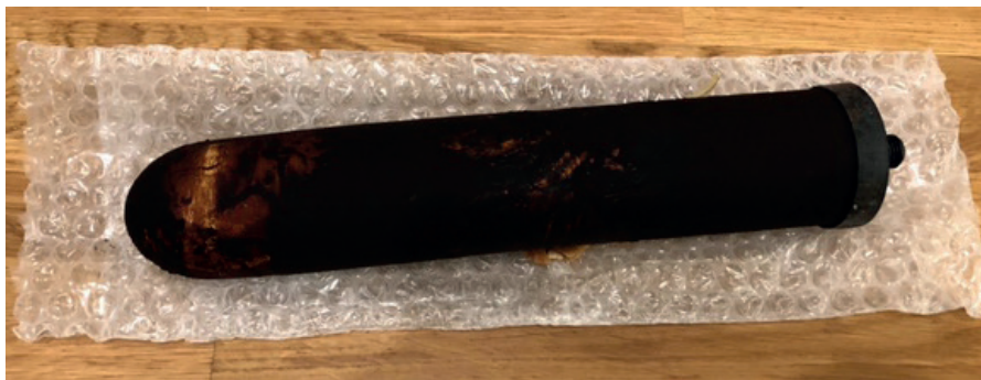
4. ÁBRA: Erősen szennyezett vízsűrő betét az ivóvízhálózatból [11]
