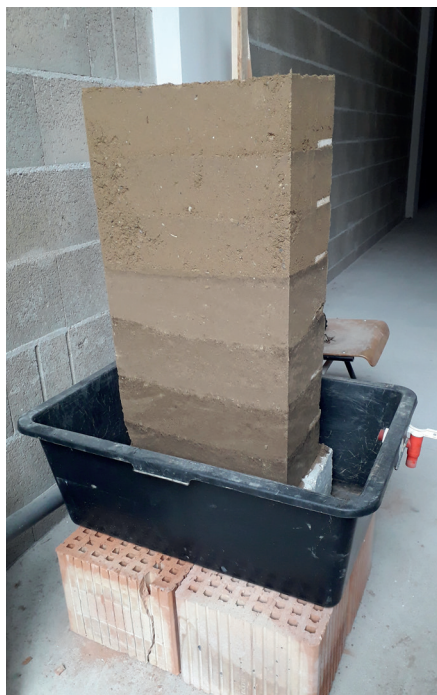
4. ÁBRA: Az elkészült próbatest felületeinek kialakítása
