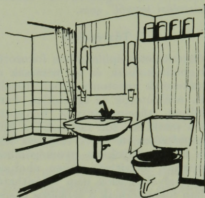
19. ábra. A műanyaghab szerelőpanel alkalmazási módjai fürdőszobában. A csőkötések a tükör, vagy faliszekrény mögött vannak. Elmarad a drága és nehezebben kezelhető szerelőakna zárólemez
