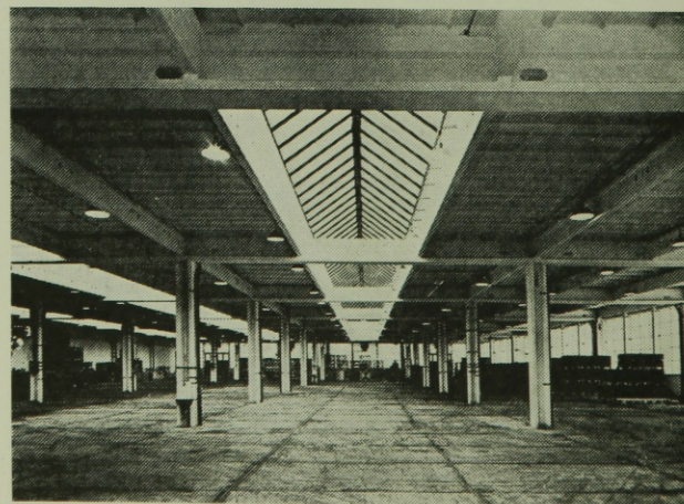
14. ábra. Többcélú típuscsarnok. Oszlopállás: 9,0 \times 9,0 m. Belmagasság: 4,20 m. Építési év: 1962.
