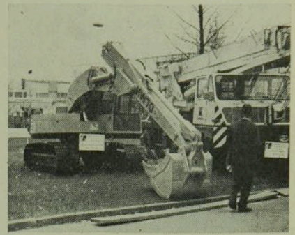
3. ábra. Weserhütte HW 70 láncetalpas hidraulikus kotró
