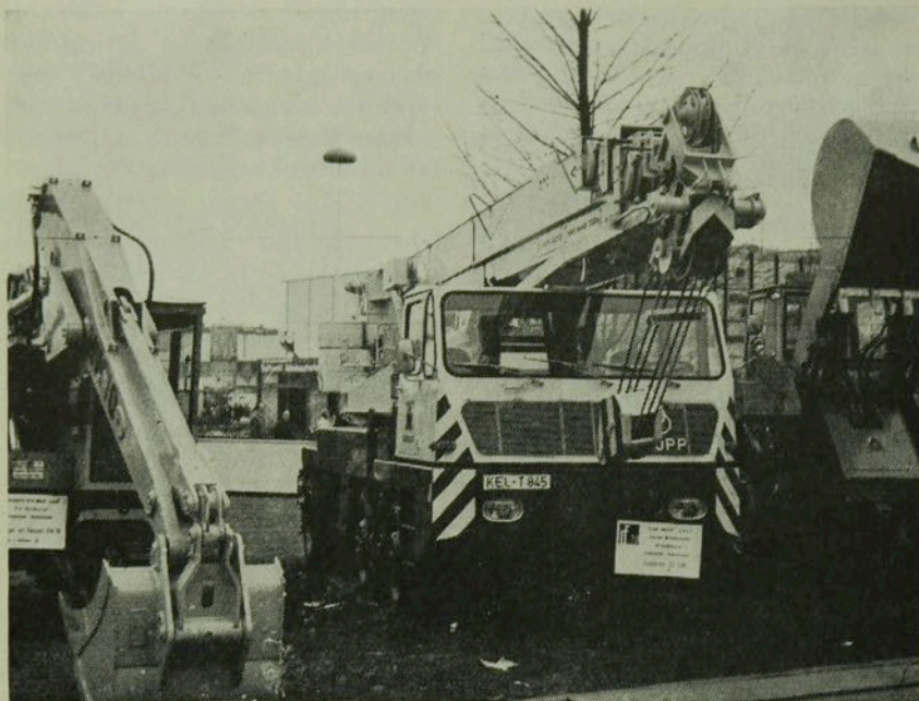
32. ábra. Krupp 20 GMT teleszkópgémes autódaru
