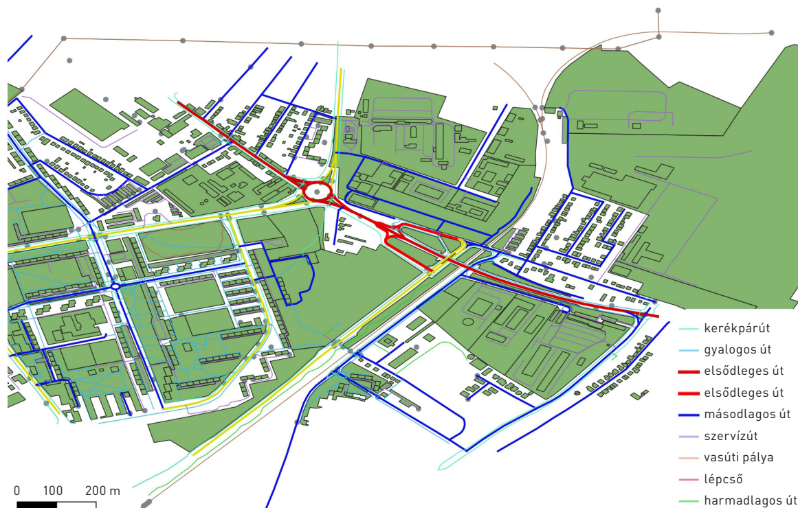
3. ÁBRA: Az OpenStreetMap adatai alapján, QGIS segítségével készített tematikus térkép a tervezési terület megközelíthetőségéről
