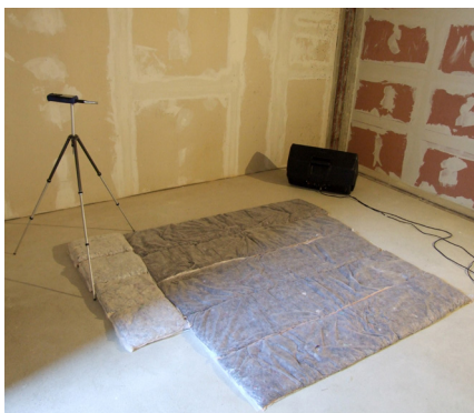
12. ÁBRA: Az utózengési idő mérése zengő szobában, a hangelnyelési tényezők számításához
