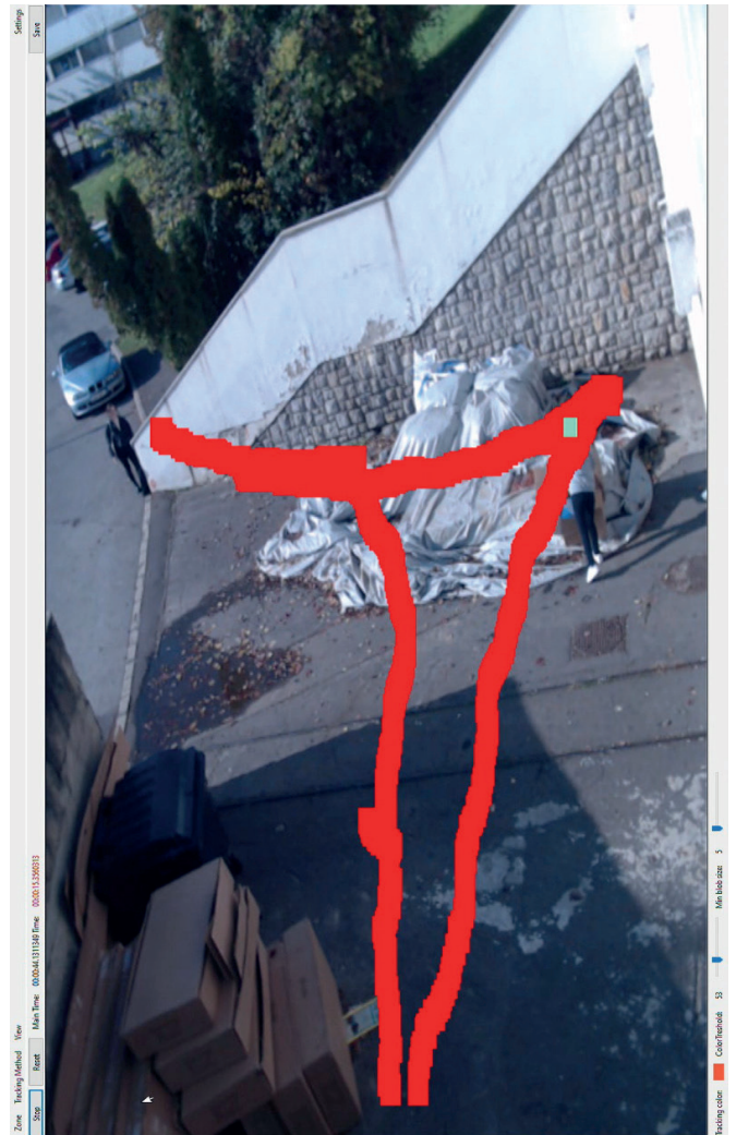
5. ÁBRA: A mozgást érzékelő, követő program és a kinyerhető útvonal
