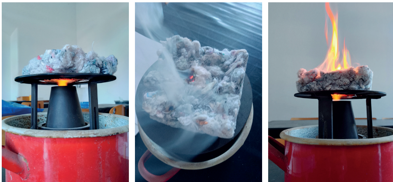
2. ÁBRA: Gyúlékonyság vizsgálat a Lindner-módszerrel.
