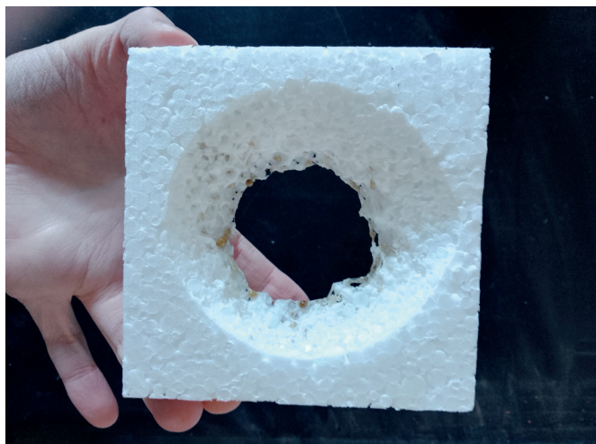
3. ÁBRA: Az EPS minta a lánghatásra 10 másodpercen belül kiolvadt
