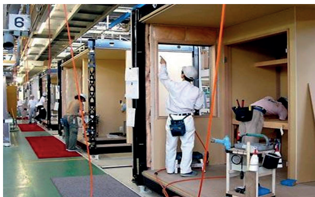
2. ÁBRA: Térelemszerelő üzem a Toyota Home vállalatnál (forrás a Toyota Home weboldala)
