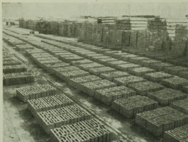
2. ábra. A 30 \times 30 \times 19 cm méretű kézi falazóblokk a gyártótelepen
