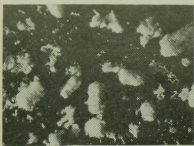
9. ábra. A házicincér álcáinak jellegzetes ürülékesomói parányi, forgácsdarabkák. (12× nagys.)
