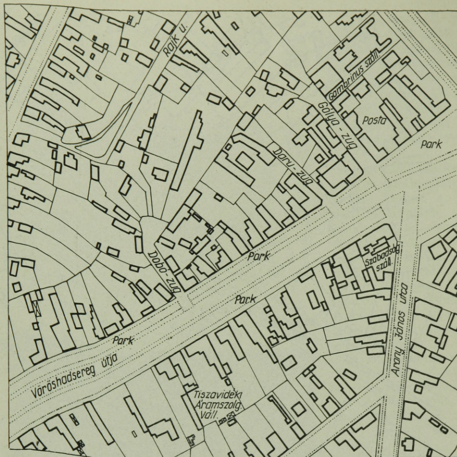
6b. ábra. Ugyanarról a területről légi sík fotogrammetriai úton készült tervezési alaptérkép
