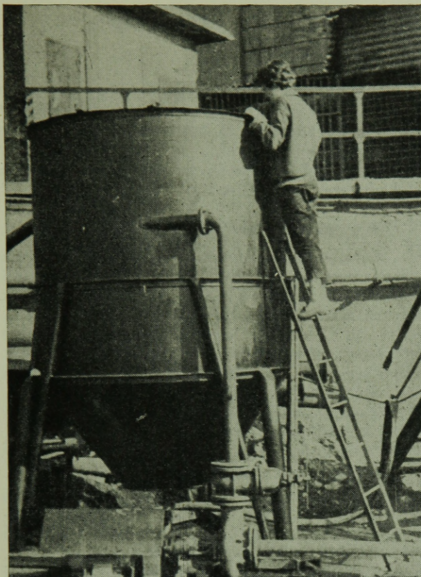
4. ábra. Félüzemi 1 : 4 méretarányú hidrociklon-modell
