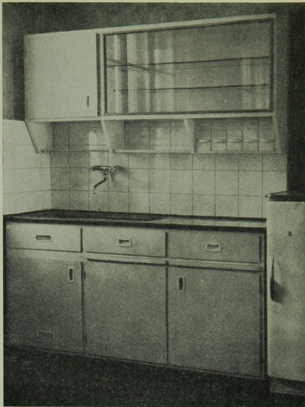
5. ábra. Beépített konyhabútor típuselemekből, 16 féle módon variálható
