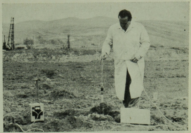
2. fénykép. Talajvíz áramlás vizsgálat Rakacán a kémlelő lyukba eresztett szondával
