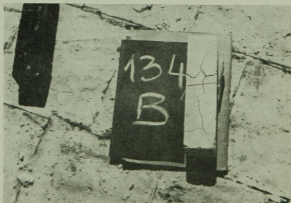
2. fénykép. Ammóniumnitrát hatására kialakult károsodás harmadik fázisa (Wallkyd bevonatrendszer)
