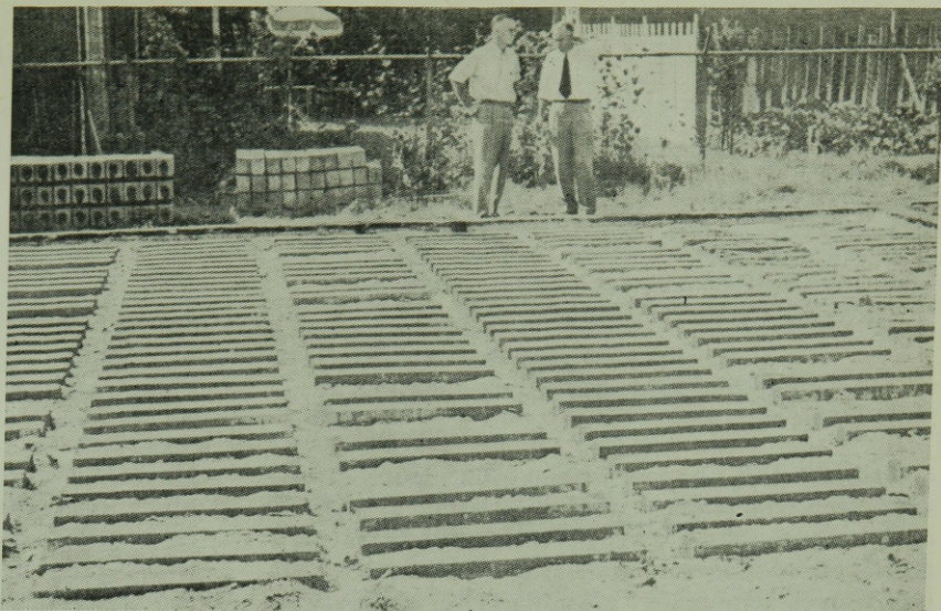
1. ábra. Betonkorróziós terepkísérlet Sacramentóban. (Portland Cement Association USA)
