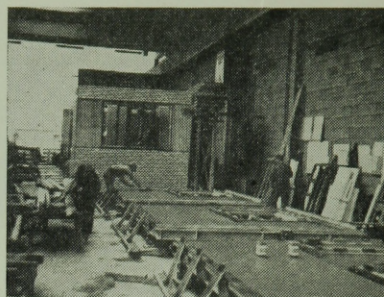
5. ábra. A felületek simítása és letisztítása
