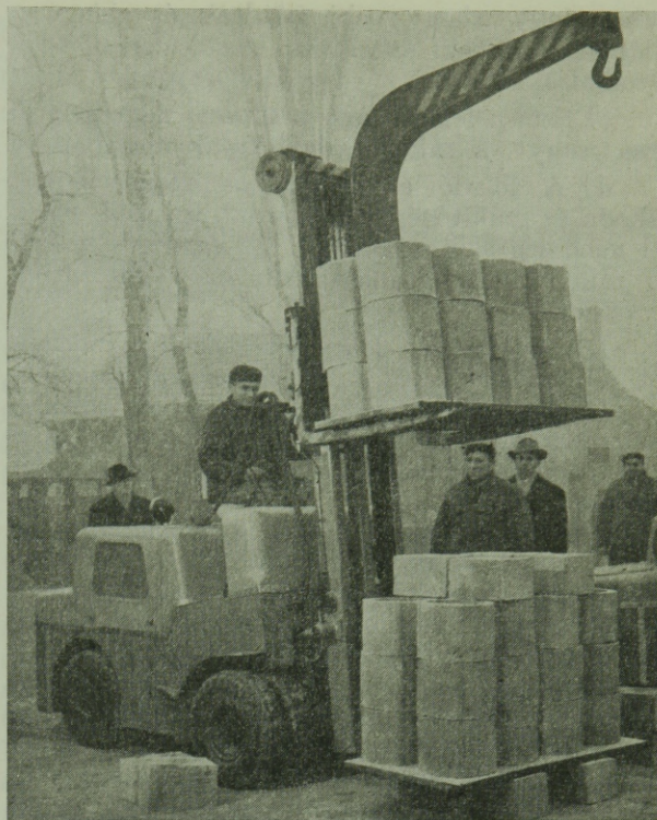
9. ábra. Termoforbélések egységrakományai rakodólapon, emelés a rakodóvillával
