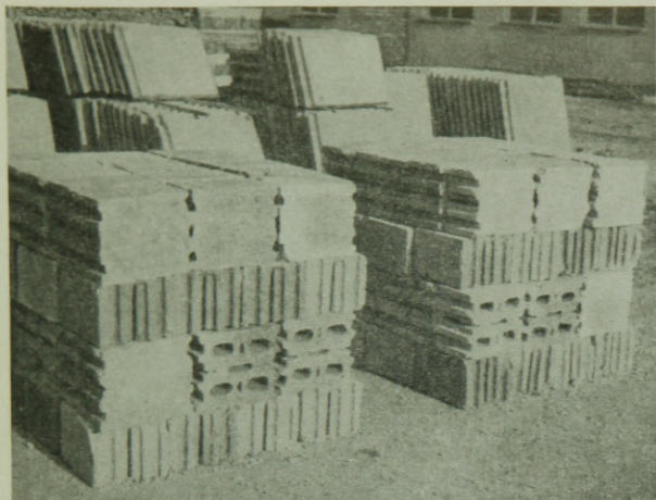
6. ábra. Tufa-falazóblokk egységirakomány szorítópfás villához
