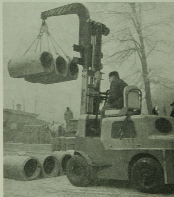
2. ábra. Nagyméretű betoncsövek emelése, segédeszköz a daru és emelőkengyel
