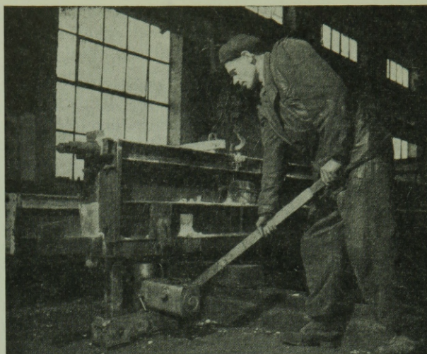
18. ábra. Hidraulikus ékkihúzó berendezés
