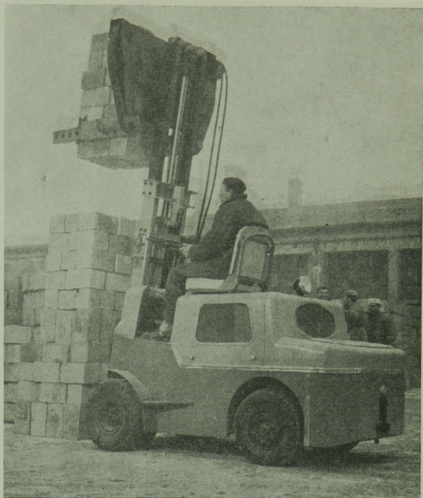
5. ábra. Bányaékkő egységrakományának emelése 2 ágú szorítópfás villával
