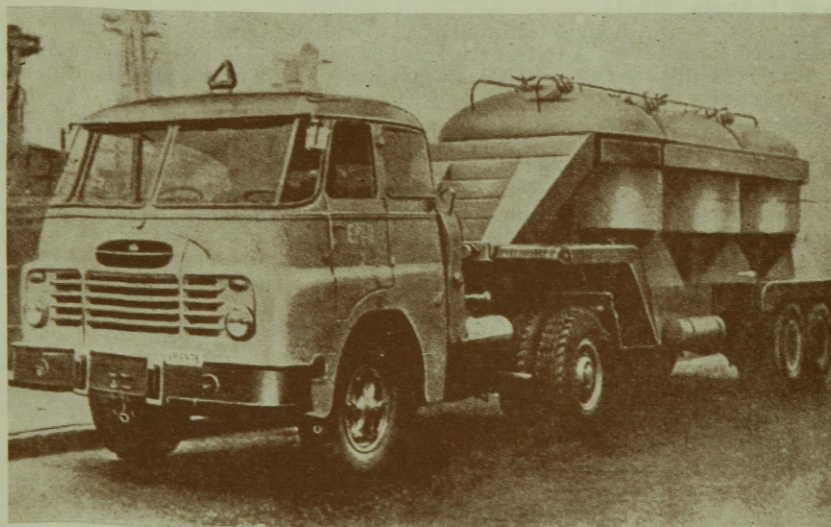
3. ábra. Csepel D 705.5-1 típusú 15 tonnás nyerges cementszállító gépkocsi
