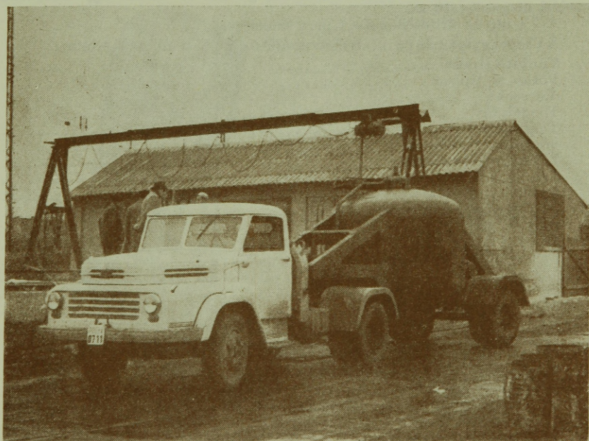
15. ábra. A 041 típusú cement- szállító gépkocsiból kifejlesztett speciális oltótmész-szállító gépkocsi
