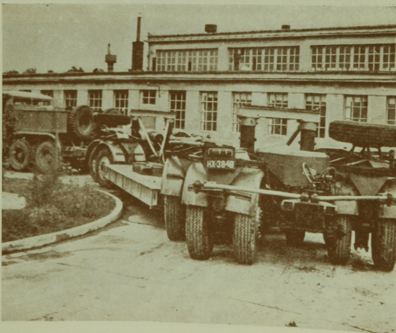
22 ábra. 40 t teherbírási összkerék-kormányzású trailer
