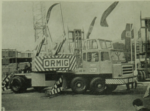
45. ábra. ORMIG 50 Mp teherbírású autódaru
