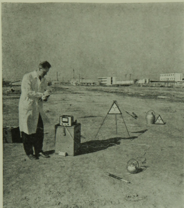
5. ábra. Felszíni tömörségmérés AKI műszerrel
