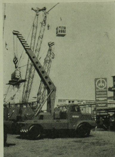
7. ábra. ADK 6,3 típusú autódarú vákuum himbával
