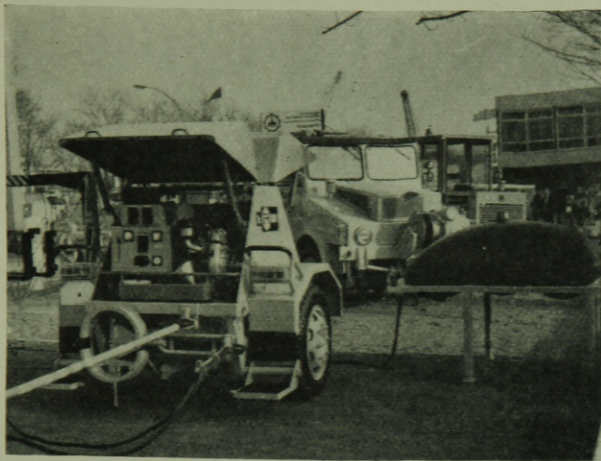
26. ábra. SUR 1 aszfaltútjavító gépesoport
