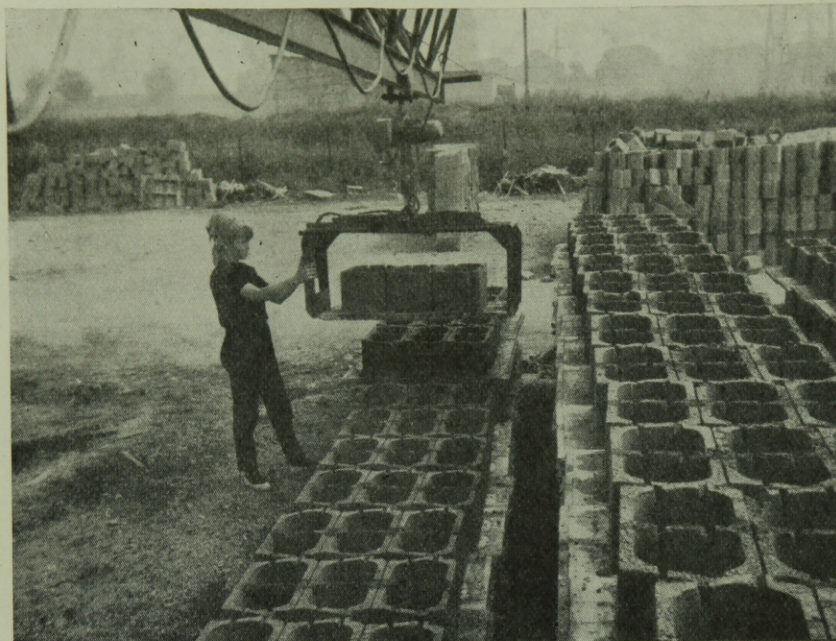
6. ábra. A friss gyártmányokat az érlelőtéren alátétálcával együtt tárolják
