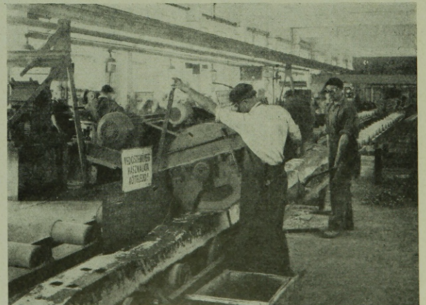
10. ábra. Huzalvágás az aljak végei között
