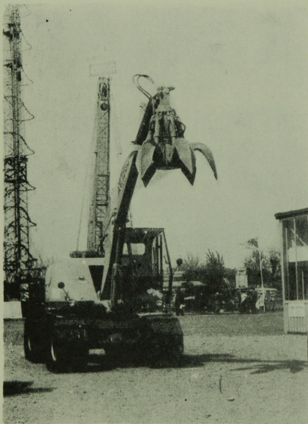
9. ábra. Atlas 1200 hidraulikus kotró mocsári lemeztagos kerekkel
