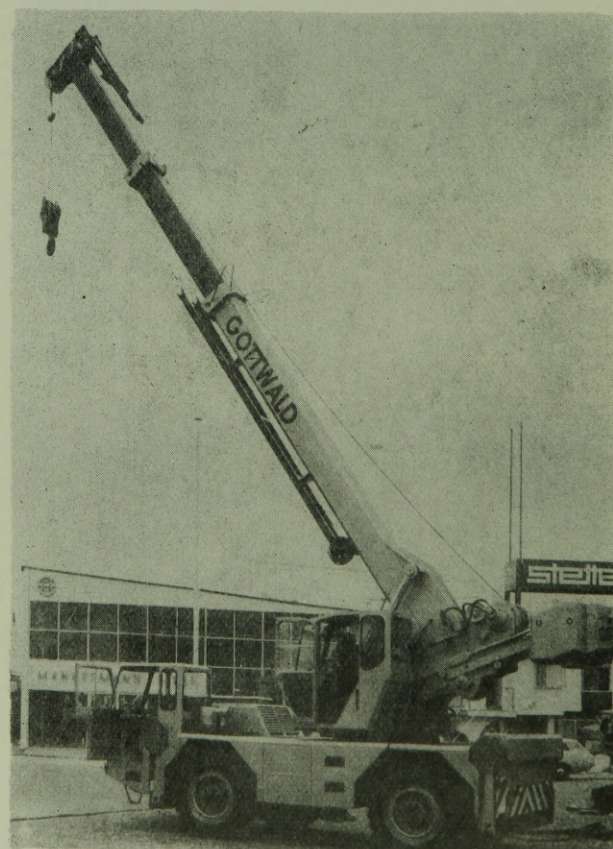
35. ábra. Gottwald AMK 45 hidraulikus teleszkópgémes autódaru
