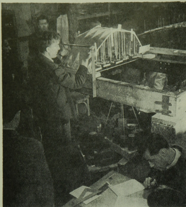
1. kép. Az V. sz. modell törési kísérlete
