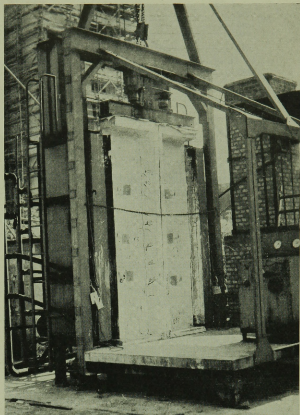
11a ábra. Bordás-lemezes falelem vizsgálat közben
