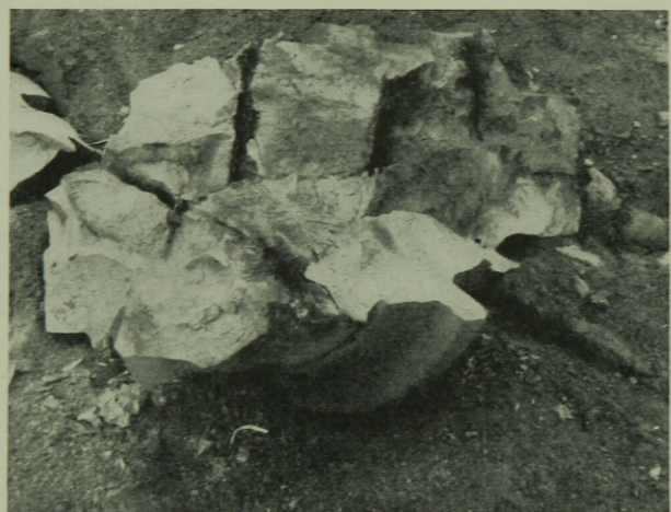
9. ábra. Szétrobbantott acélhenger képe
