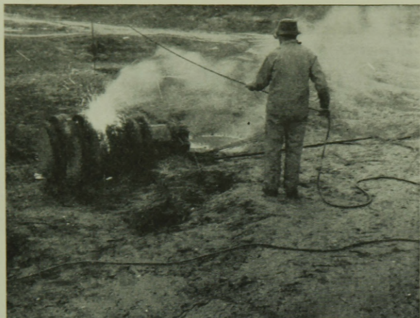
8. ábra. Acélhengerek robbantásához szükséges robbantólyukakat oxigénlándzsával készítik el
