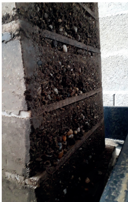
7. ÁBRA: A próbatest lécbetákos oldalának eróziója a kísérlet után
