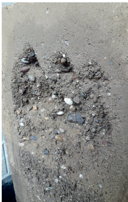
6. ÁBRA: A próbatest natúr oldalának eróziója a kísérlet után
