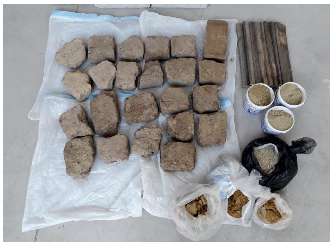
3. ÁBRA: A faltest készítéséhez felhasznált anyagok és előkészítésük
