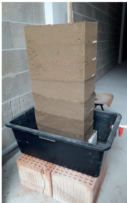
4. ÁBRA: Az elkészült próbatest felületeinek kialakítása
