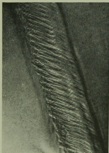
10. ábra. A hegesztési műveletnél a két felmelegített fóliát — a görgős vasalóval egymásra keresztirányú mozgással — tökéletesen egymásra préselik. A két anyag teljesen egybeforr
