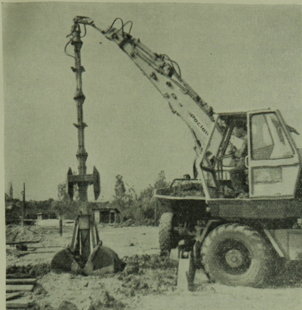
3. fénykép. POCLAIRN T. Y. 45 típusú markoló-réselőgép
