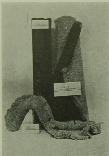
32. ábra. A TIZOL—KN úsztatórég anyagai: TIZOL—T viscosa alapú tépett és kártolt rugalmas vattapaplan és bitumenes csupaszlemez
