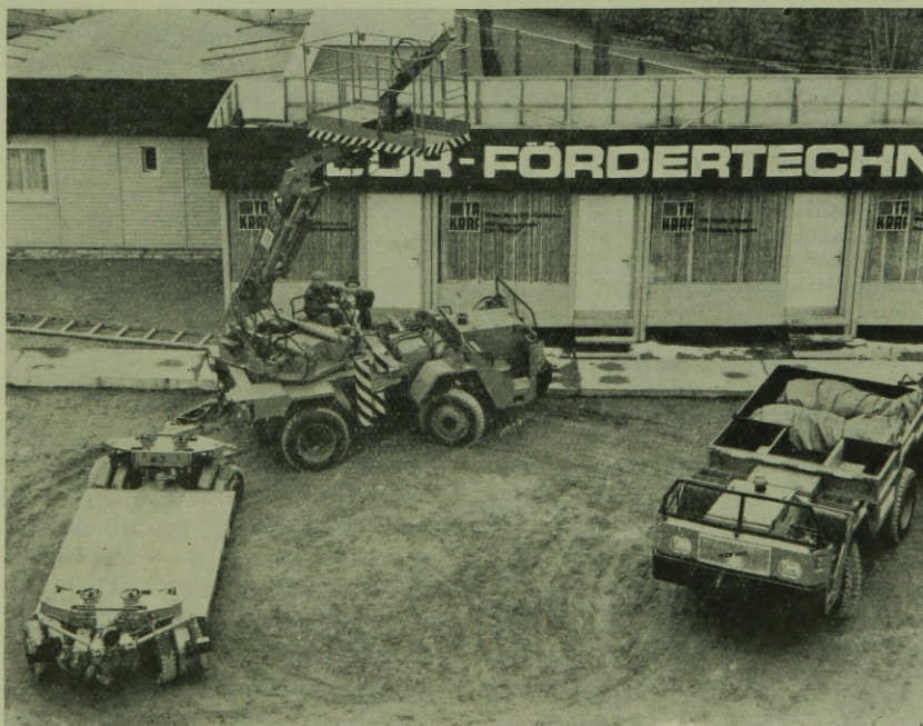
13. ábra. Egytengelyes kisvontató hidraulikus szerelőkosárral
