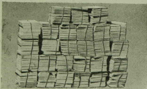
3. ábra. Csempék szakszerűtlen tárolása. Lapjára fektetett rakás esetén a lapok még rakás közben is könnyen repednek, törnek, csorbulnak és 1 méter magasságban felrakott kötegek alsó lapjai a terhelés következtében fokozottabban csorbulnak, törnek. Az ilyen rakodásnál a lapok könnyen széteúsznak, eldőlnék és a sok lap-törésen kívül balesetet is okoznak
