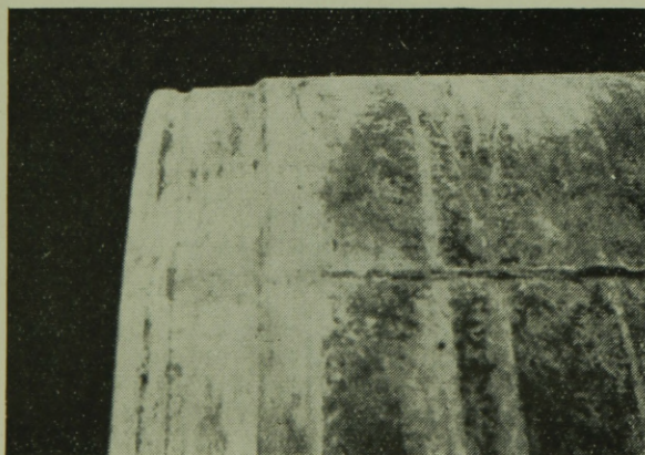
9. ábra. Vianini-cső vége a gumigyűrű részére készített horonnyal.
