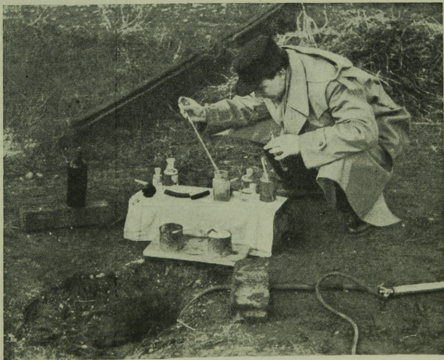
6. ábra. Talajvízminta helyszíni vegyi-vizsgálata
