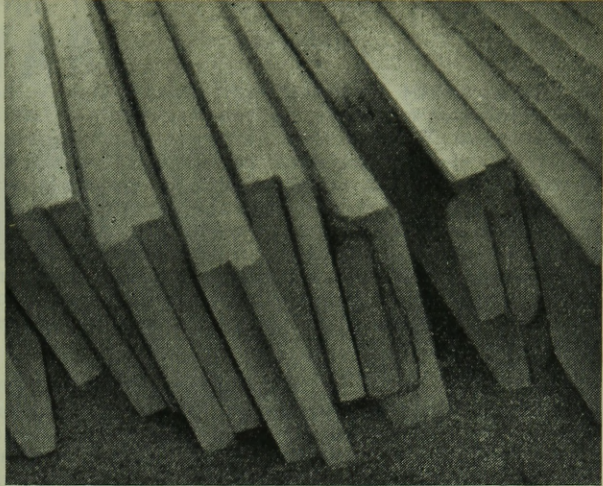
8. ábra. A kirakodásnál megsérült földémelem.
