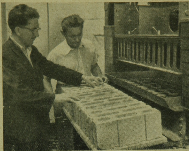
4. ábra. Falazó testeket gyártó hidraulikus vibrálás
