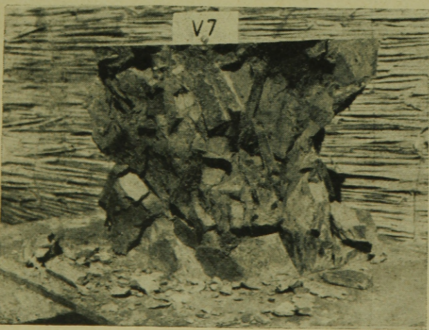
12. ábra. V7-jelű keverékből készült, 30 cm élhosszúságú kocka törés után
