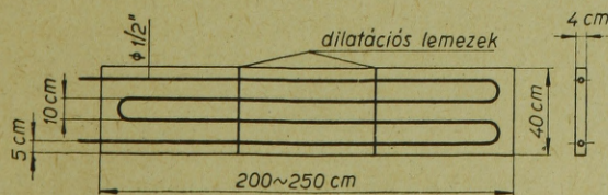
5. ábra. Beton fűtőlap csőváza (csőkígyó)
