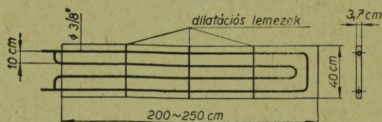
9. ábra. Beton fűtőlap csőváza ráerősített lemezekkel
