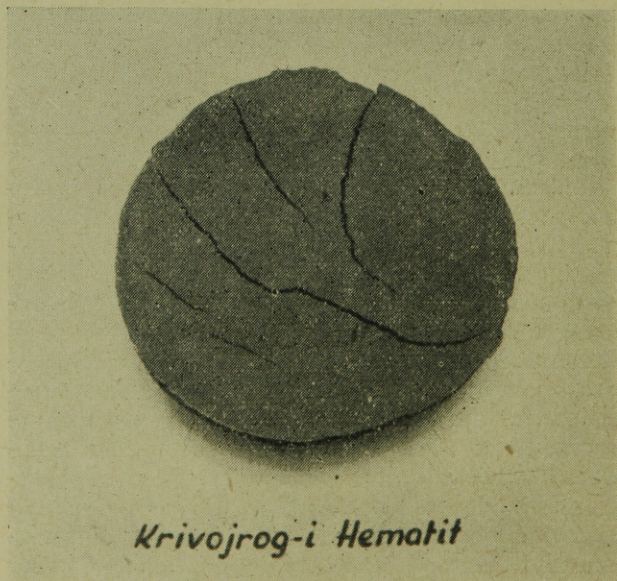
3. ábra. Hematitporral készített lepeny zsugorodási repedései
