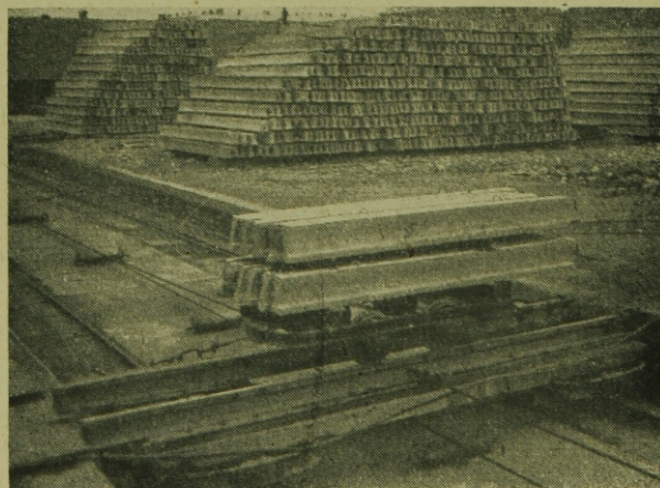
5/a–f. ábra. „L” gerendagyártás folyamata az 5. sz. Épütelelemgyárban
