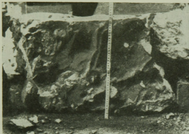
7. ábra. Limbergi nyomócső; prepakt beton kísérleti test törés után A prepakt habarcs megállapíthatóan kitöltötte a kavics hézagait
