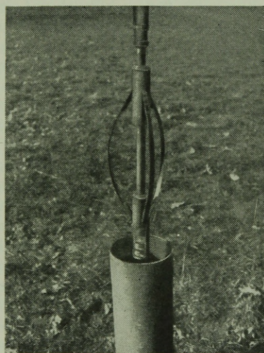
18. ábra. Kaliberező leeresztés a furatba
