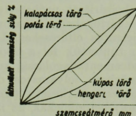
3. ábra. Különböző aprítógepeken megtört kemény kőzet szemszerkezeti görbéi
